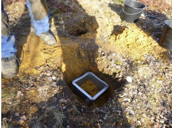
Schurf mit Stechrahmen (Entnahmebereich A)
