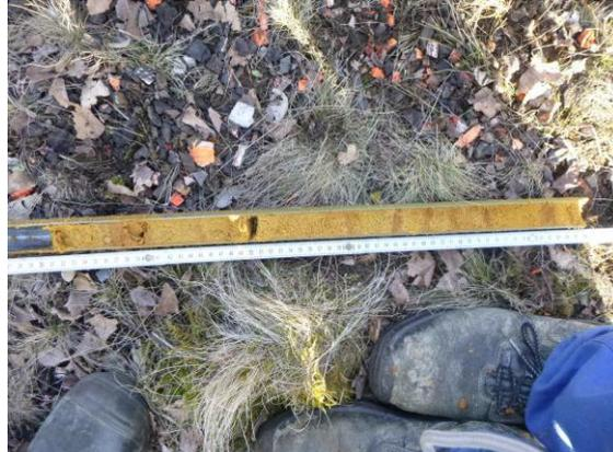
Probennahme mittels Bohrstock ab 30 cm bis 100 cm uGOK (Entnahmebereich A)
